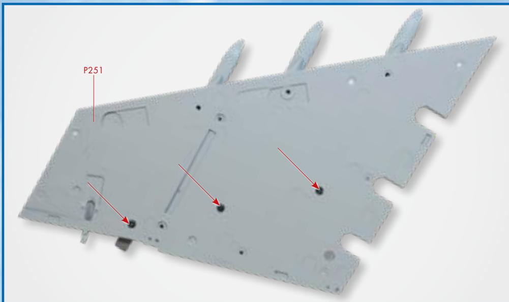
**4** Зафиксируйте пилоны винтами ММ с внутренней стороны нижней обшивки (P251), как показано на снимке.
