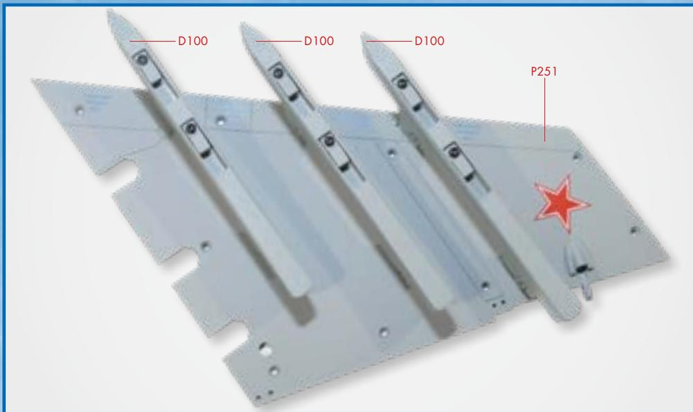
**3** Затем установите пилоны (D100) на нижней обшивке левой консоли крыла (P251), как показано на снимке.
